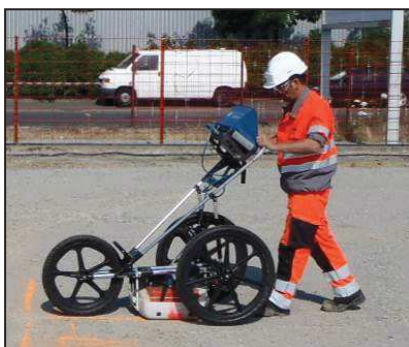
Détection par Géoradar
