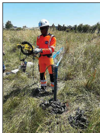
Vérification avec la sonde en fond de forage
