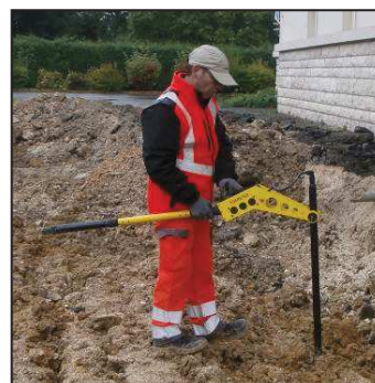
Détection par magnétomètre
