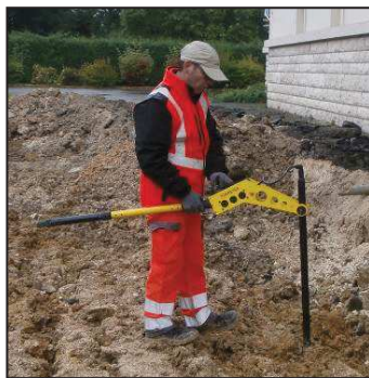
Détection par magnétomètre
